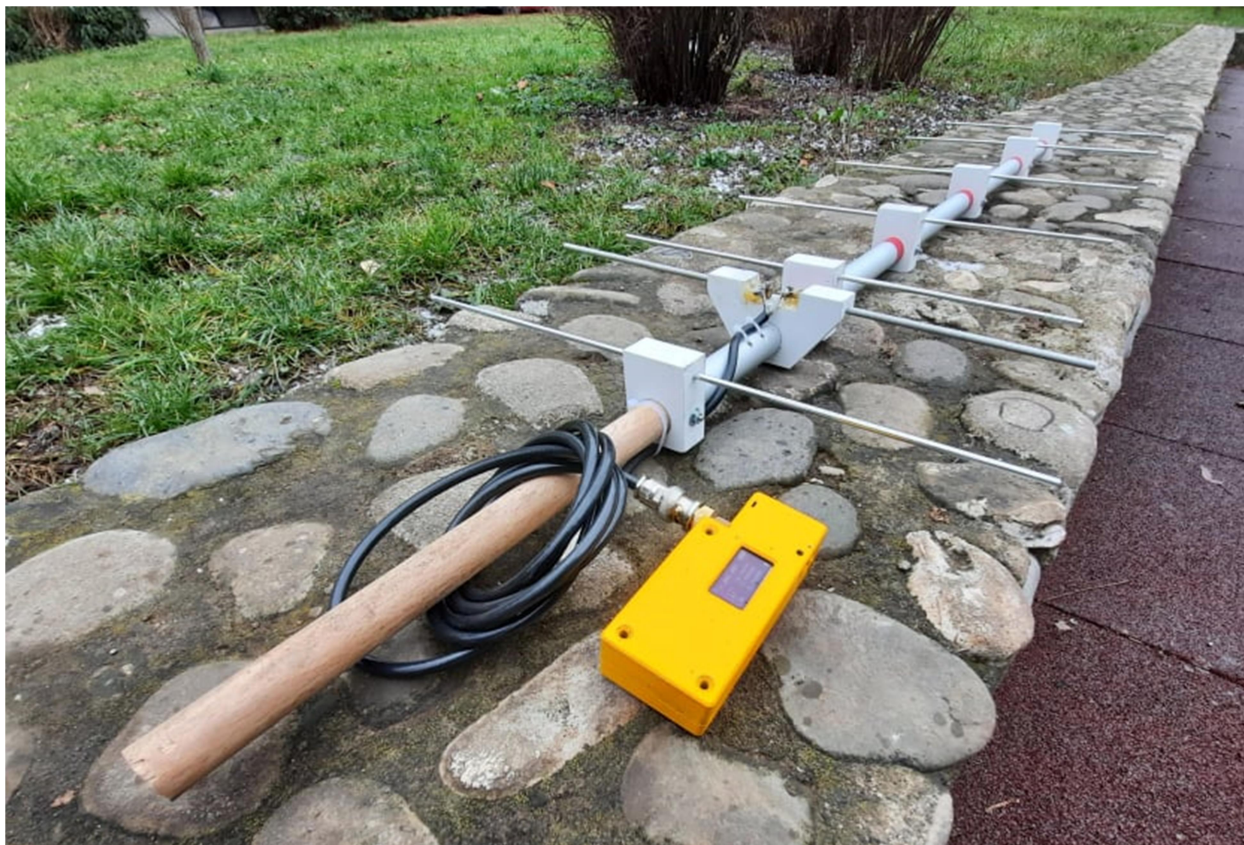
Slika5 Yagi antenna imikrokontrolerkojesmokeristili za lovnaradiosondu
